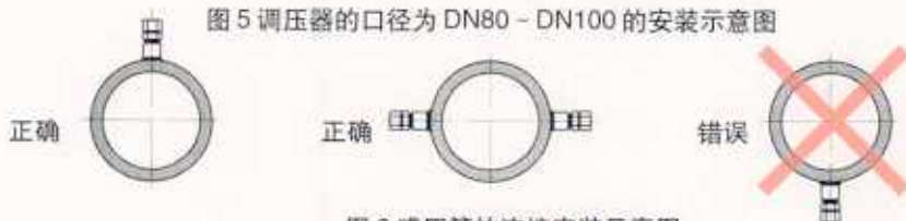
图 6 感压管的连接安装示意图
